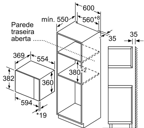
\* 20 mm para frente metálica Medidas em mm
