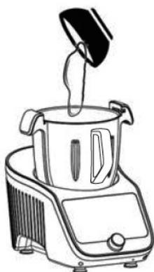
Versez 600 ml d'eau au minimum et 1.5 L d'eau au MAX dans le bol de mixage.
