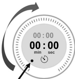
Le bouton tactile central avec l'icône
