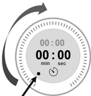
O botão tátil central com o ícone permite ajustar manualmente a duração de cozedura ou de mistura.
