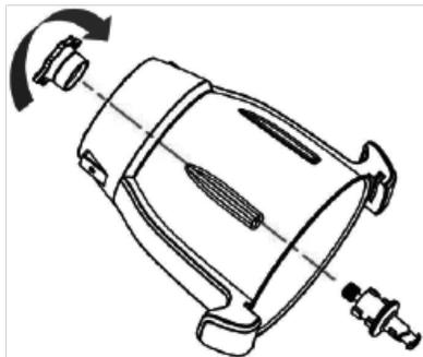
Placez le bol à l'horizontale sur le plan de travail. Insérez l'axe d'entraînement dans le trou situé dans le bol et appuyez sur l'axe. Ajustez le verrou sur la base de l'axe et tournez le verrou dans le sens des aiguilles d'une montre pour verrouiller.
