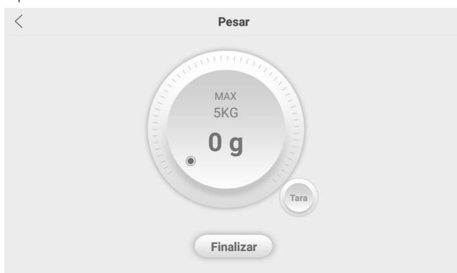
Coloque o ingrediente no copo de mistura, o ecrã exhibe o peso. Se adicionar outro ingrediente ao copo, o seu peso acresce ao exibido. Se pesar os próximos ingredientes, pode utilizar a função Tare da seguinte forma: carregue no ícone Tare, o ícone exhibe 0 g, e adicione o segundo ingrediente ao copo. Repetir o procedimento para os próximos ingredientes.
