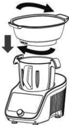
Coloque o recipiente de vapor no copo de mistura tendo o cuidado de posicionar as pegas às 1 h e às 7 h para que as linguetas do recipiente de vapor encaixem corretamente nas ranhuras das duas pegas.
