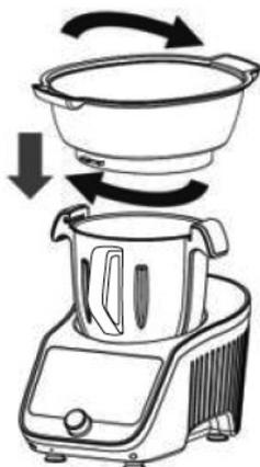
Placez le bol vapeur sur le bol de mixage en veillant à positionner les poignées à 1h et à 7h afin que les languettes du bol vapeur puissent s'emboîter correctement dans les enfoncements des deux poignées.
