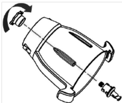
Coloque o copo na horizontal na bancada. Insira o eixo de movimentação no orifício situado no copo e pressione o eixo. Ajuste o bloqueio na base do eixo e rode o bloqueio no sentido dos ponteiros do relógio para bloquear.
